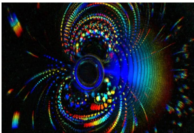
Rysunek 1. Dynamika obrotu cząstek w wirze fonicznym (kolor odpowiada poszczególnym etapom ruchu).
